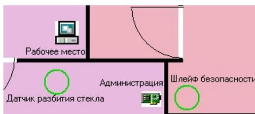
Параметрами элемента, отображающего устройство на плане, являются его размещение на плане, параметры прямоугольной рамки (толщина, цвет и цвет заполнения). Необходимо также указать, какое именно устройство или шлейф будут связаны с этим элементом.
